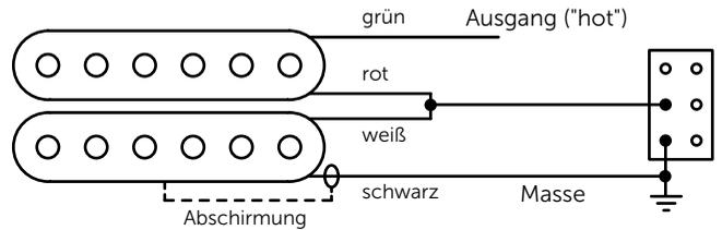
Die vieradrige Ausführung der Duesenberg Pickups ermöglicht auch Parallel-, Out-of-Phase- und andere Schaltungen.
