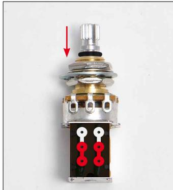
Zwei Beispielschaltungen mit „Reverse Killswitch“. Zur Aktivierung der „Kill“-Funktion wird das Volume-Poti auf Null gedreht. Beim Drücken auf den Volume-Knopf ertönt das Gitarrensinal. Beim Loslassen - Stille!
